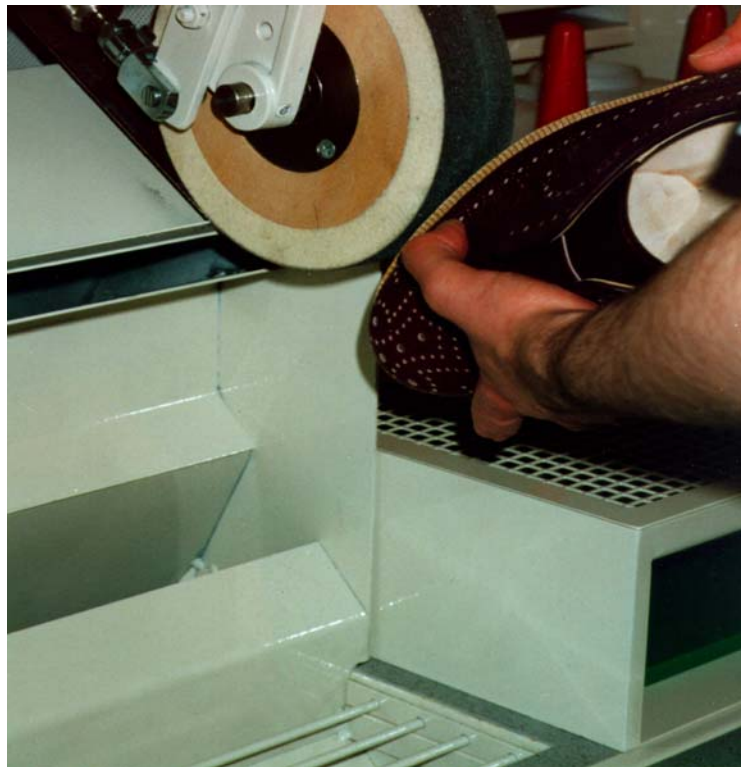
Abbildung 3-14: Sensorgesteuerte Lüftungsklappen beim Schleifen
